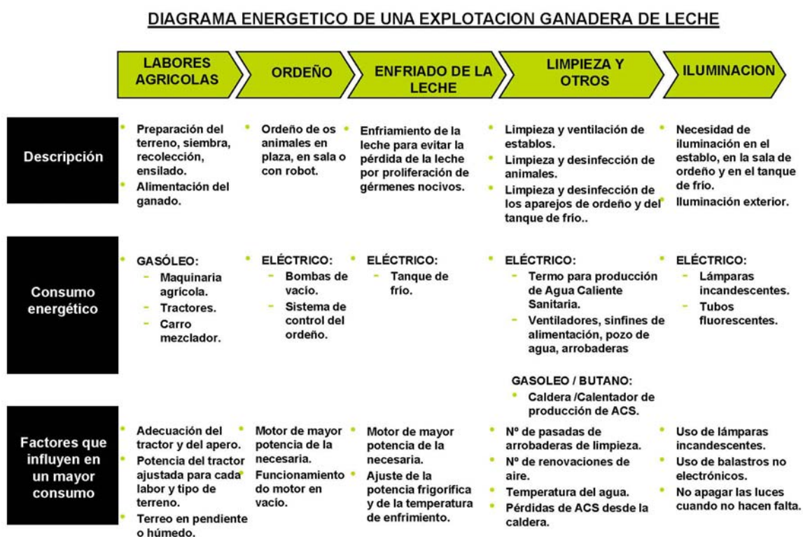
Figura 5. Diagrama energético en la explotación ganadera de leche.
